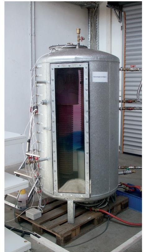
Wärmeschichtenspeicher auf der Teststation: exakte Schichtung, bzw. Temperaturschichten, welche für die Energieeffizienz von grösster Bedeutung sind.
